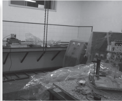
Figura 5. Montaje experimental RAMA II con Vibrometría Laser Doppler y mitigación de efectos EMI.
