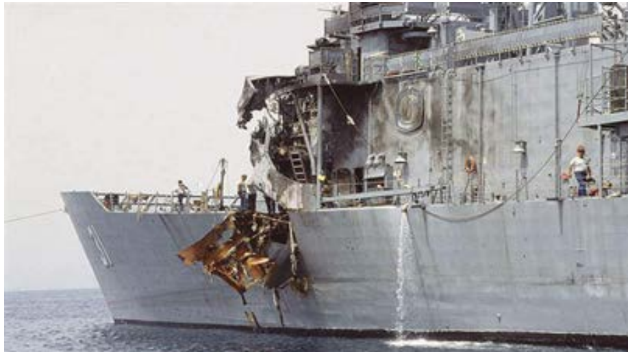
Imagen de la fragata USS Stark luego de ser impactada por un misil lanzado desde una aeronave iraquí. Fuente: https://www.navylookout.com/uss-stark-hit-by-exocet-missile-gulf/
